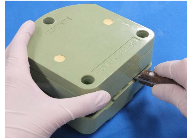
埋没材硬化後、 フラスクを分離する
